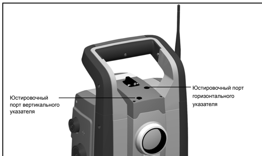
Рис. 4.29. Юстировочные порты лазерного указателя
