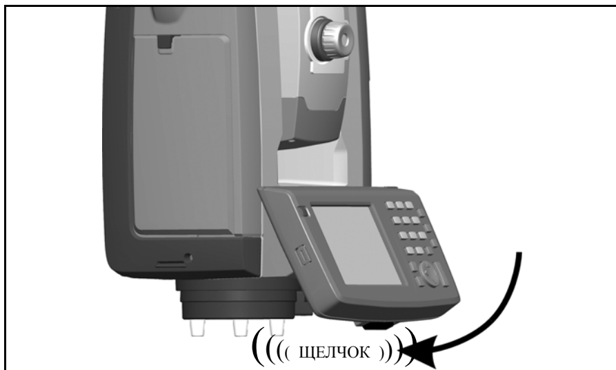
Рис. 4.36. Установка контроллера Trimble CU
