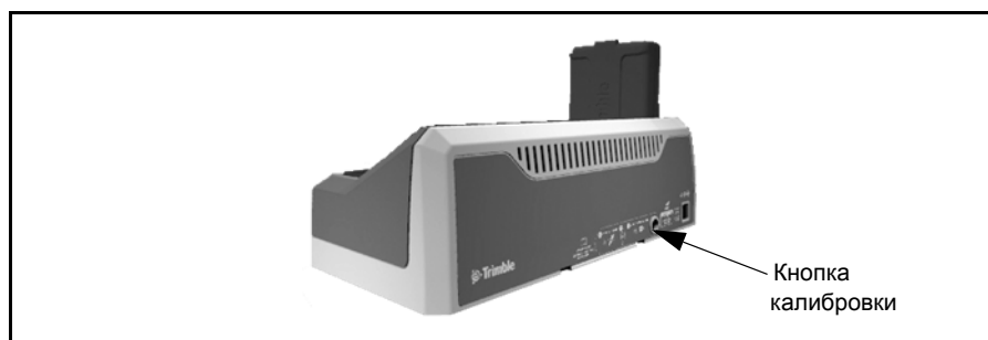
Рис. 3.11. Кнопка калибровки на зарядном устройстве
