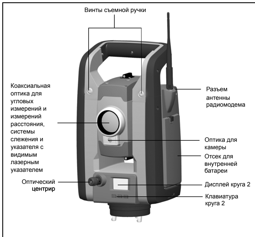
Рис. 3.16. Пространственная станция Trimble VX, вид спереди
