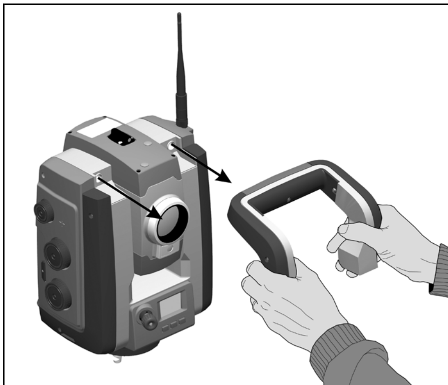
Рис. 3.21. Отсоединение ручки инструмента
