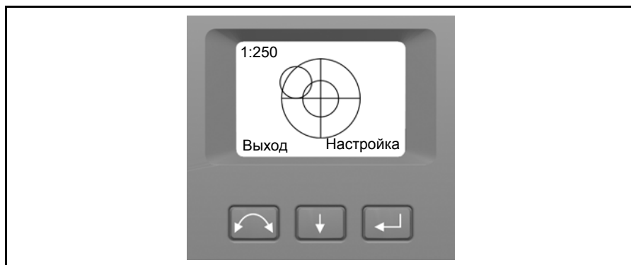
Рис. 3.18. Окно электронного горизонтирования на дисплее круга 2
