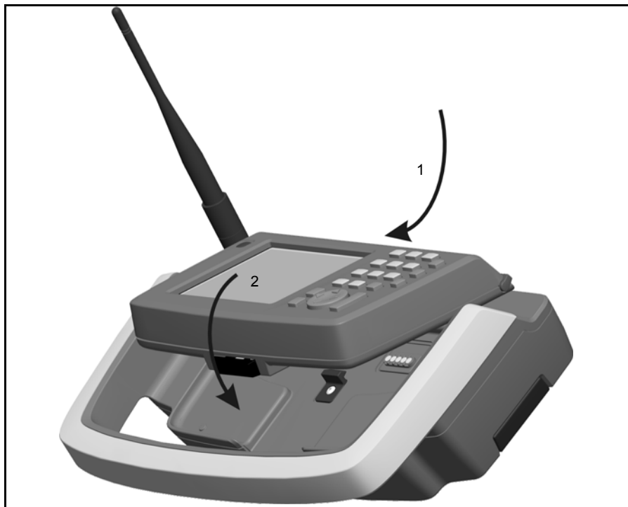
Рис. 7.68. Подсоединение контроллера Trimble CU к держателю Trimble Robotic
