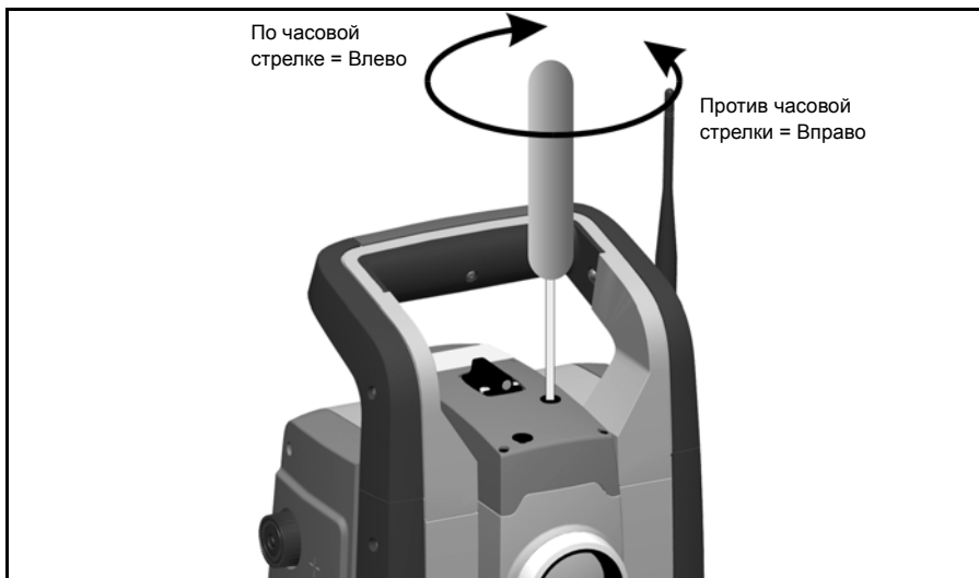
Рис. 4.31. Юстировка горизонтального положения
