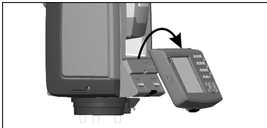
Рис. 4.38. Отсоединение контроллера Trimble CU
