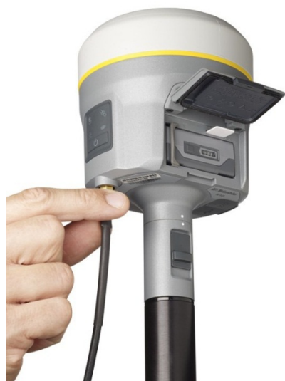
Присоединение кабеля внешней антенны к приемнику
