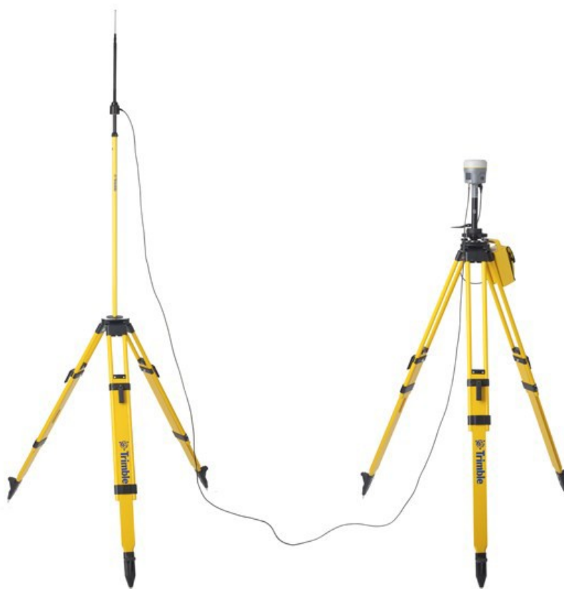
Присоединение кабеля внешней антенны к приемнику
